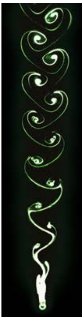
Unité de mécanique (UME) Sillage d'un cylindre, allée tourbillonnaire de Bénard - von Karman
